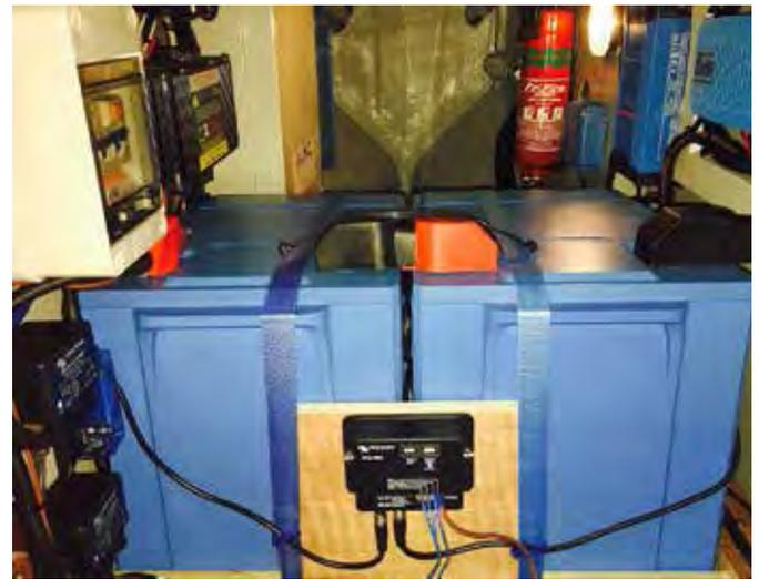
Das Foto zeigt 2 x 12,8 V 200 Ah Lithium-Eisenphosphat-(LiFePO<sub>4</sub> oder LFP) Antriebsbatterien mit Zellenausgleich und BMS (in der Mitte).
