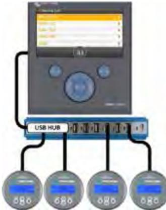
Es können bis zu vier BMVs direkt mit einem Color Control verbunden werden. Es lassen sich sogar noch mehr BMVs an einen USB-Hub anschließen, um zentral überwacht zu werden.
