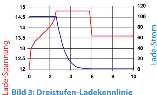
Bild 3: Dreistufen-Ladekennlinie
